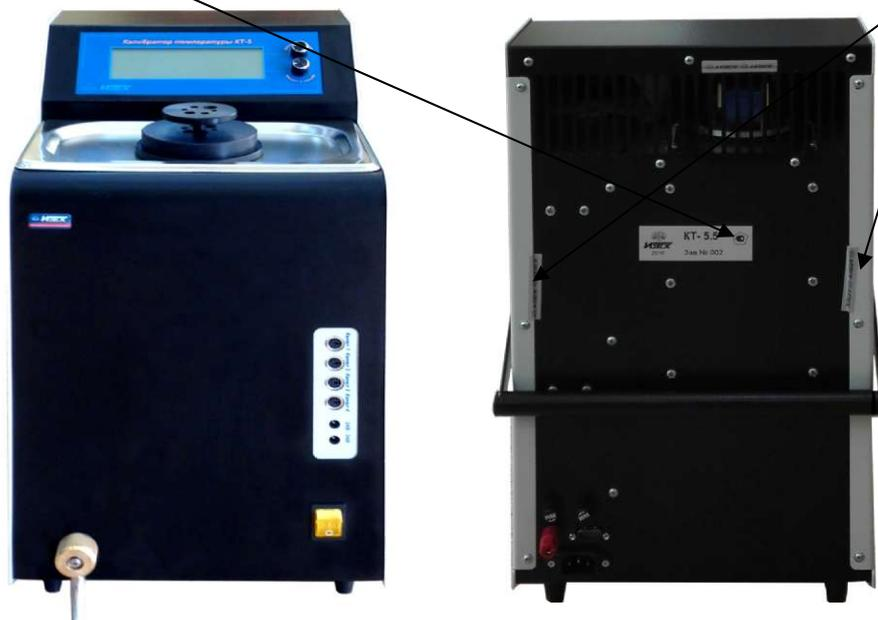
Рисунок 4 - Внешний вид калибратора температуры КТ-5 (модификация КТ-5.5)
